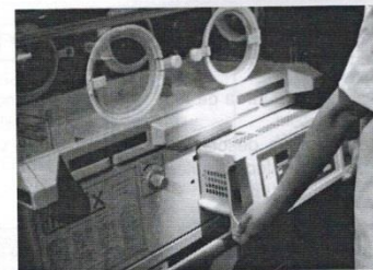
Figura 21: Desmontaje del grupo motor
